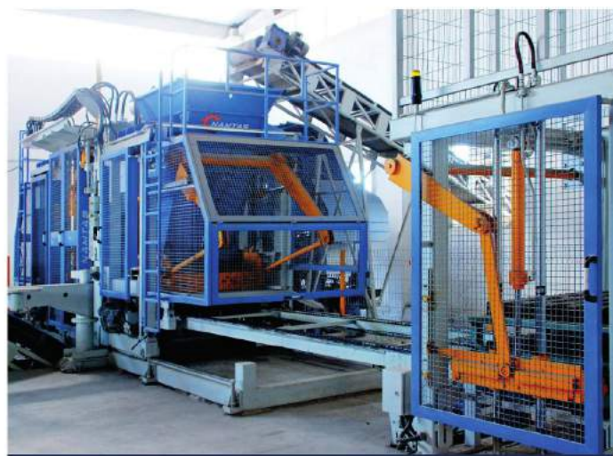
Конвейерная подача бетонной смеси в линии NS-36/A
