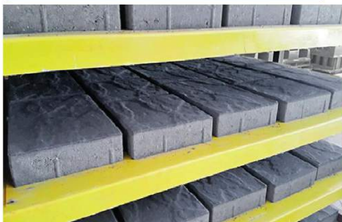
Благодаря рельефным пуансонам возможно производство бетонных изделий с текстурной поверхностью
