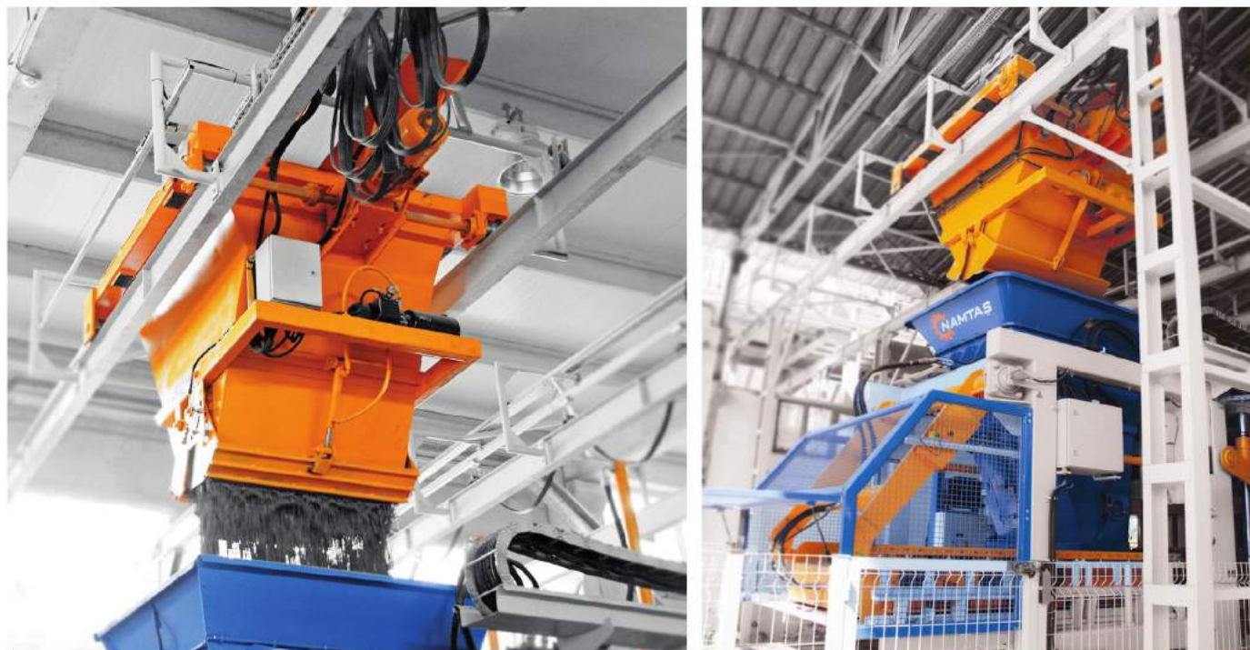
Выгрузка бетонной смеси из кубеля в вибропресс
