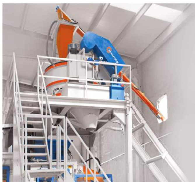
Планетарный бетоносмеситель MP-1000, расположенный над вибропрессом NT-42
