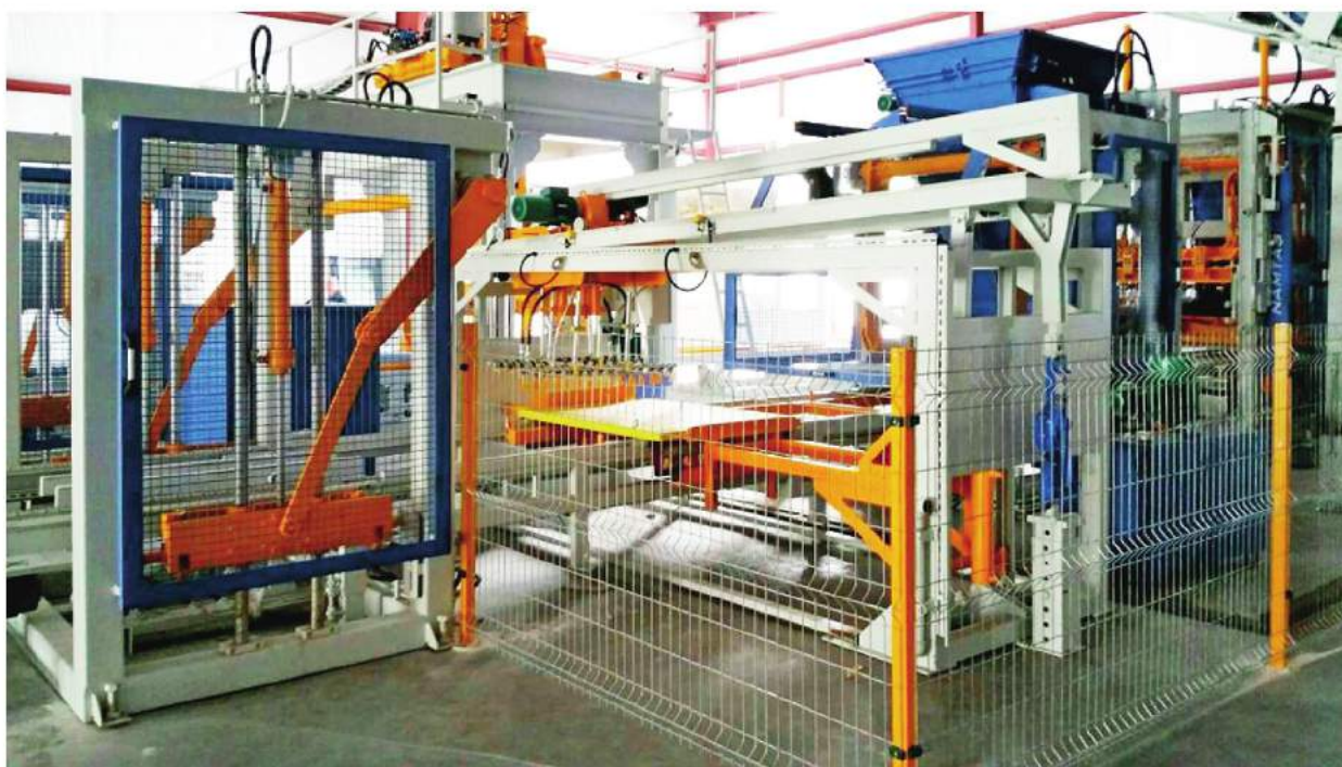
Мощная станция устанавливается в линию между вибропрессом и лифтом-накопителем.
