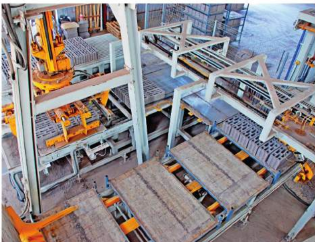
Пост группировки блоков в линии NS-36/B
