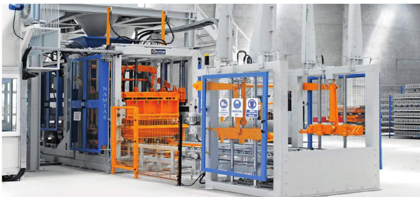
Технологическая линия для изготовления стеновых блоков на базе вибропресса NT-42
