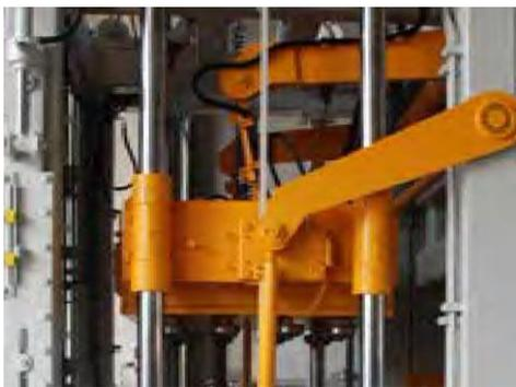
Les supports de moules et de têtes de compactage sont montés sur quatre colonnes de guidage chromées. Ces colonnes sont soutenues par des roulements linéaires, qui stabilisent la structure entière pendant le cycle de production. Le moule est fixé au porte-moule via 4 airbags. La tête de compactage est fixée au support de tête de compactage via 12 pinces pneumatiques
