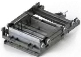
La grille d'agitateur à entraînement hydraulique, montée à l'intérieur de la boîte de remplissage en béton de base, assure un remplissage rapide et uniforme de toutes les cavités du moule. En conséquence, tous les produits en béton ont la même densité et les mêmes dimensions.
